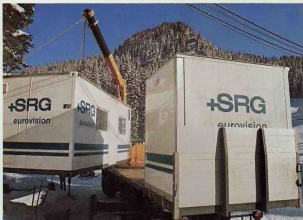
Die technische Ausrüstung des Schweizer Fernsehens für Eurovisions-Übertragungen kann in Form von Containern an die Schauplätze transportiert werden.
